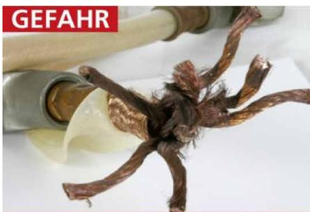
Ca. 30 Jahre alte Garnitur mit Querschnittsminderung durch Kupfer-Korrosion
