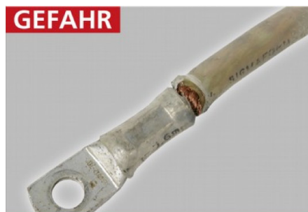
Hervortreten des blanken Leiterseils an gebrochener Seileinführung
