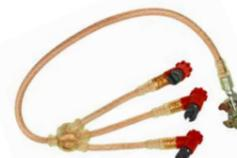
**NH-Erdungsvorrichtung 25mm<sup>2</sup> vollisoliert**, inkl. Erdanschlussklemme max. Kurzschlussstrom 7kA/0,5s
