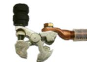
**Erdanschlussklemme kompakt** für Flachleiter 9-18mm, Rundleiter bis Ø 18mm, Sechskant: SW17 und SW19, max. Kurzschlussstrom 7kA/0,5s
