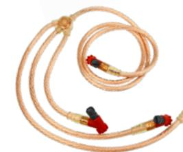
**NH-Erdungsgarnitur 35 mm<sup>2</sup> vollisoliert**, für NH-Schaltleisten max. Kurzschlussstrom 10kA/0,5s
